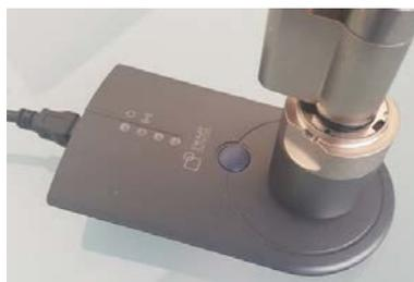
Während der Programmierung über das WaveNet muss das SI.SmartCD nur an einem freien USB-Anschluss angeschlossen sein, bis die erste Schließung programmiert ist. Danach ist die Konfiguration vollständig im SmartIntego-Tool gespeichert und das SI.SmartCD kann entfernt werden.
