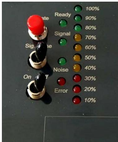
Mit dem SimonsVoss-WaveNet-Testwerkzeug (BAMO.EU) kann eine Bestandsaufnahme der Situation während der Messung gemacht werden. Das Objekt, in dem das Projekt realisiert werden soll, sollte nach der Messung nicht mehr verändert werden. Deshalb ist eine Messung in einem unfertigem Gebäude bzw. in einem Rohbau nicht zu empfehlen. Das BAMO liefert mit zwei Messungen drei Werte:
