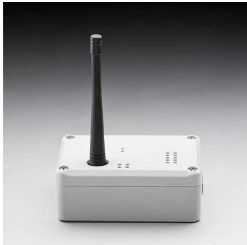
Der GatewayNode Radio-Radio öffnet an einem vorhandenen Segment ein neues Segment (über die Radio-Schnittstelle). Ein normales Segment kann maximal einmal mit einem Repeater erweitert werden, aber an einem normalen Segment können zwei voneinander unabhängige GN.R angeschlossen werden (Y-Form).
